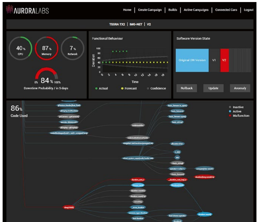
BILD 1 Die Line-of-Code Behavior Technologie analysiert Software und erstellt darauf basierend eine Übersicht, wie sich Softwarefunktionen gegenseitig beeinflussen (© Aurora Labs)
